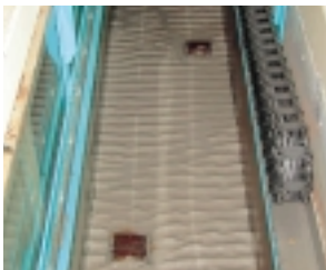
造波水路での底質安定機能模型実験
